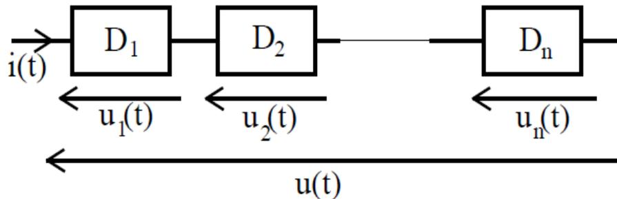
En adoptant la même convention d'orientation des tensions pour chaque dipôle, l'association série des dipôles est équivalente à un dipôle unique traversé par le courant  $i(t)$  et soumis à la tension  $u(t)$  égale à la somme des tensions aux bornes de chacun des dipôles par application de la loi des mailles :
