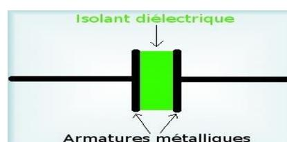
Lorsque la tension est variable sur un cycle, l'énergie sera stockée durant une partie du cycle puis restituée durant l'autre partie du cycle. On le modélise par une capacité  $C$  en parallèle avec une résistance de fuite  $R_f$ . Un condensateur est dit idéal si  $R_f$  tend vers l'infini.
