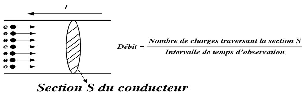
On considère l'établissement d'un champ électrique  $\vec{E}$  qui permet le déplacement des charges électriques avec une vitesse proportionnelle à  $\vec{E}$ . Cette vitesse notée  $\vec{v}$  est égale à :
