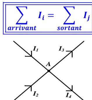
Au nœud  $A$  on a :  $I_1 + I_2 = I_3 + I_4$ .
