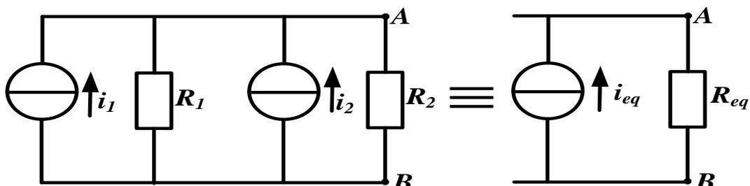
$$i_{\text{éq}} = i_1 + i_2 \quad \text{et} \quad R_{\text{éq}} = \frac{R_1 R_2}{R_1 + R_2}$$
