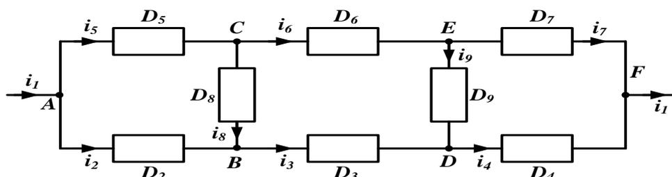
1. On donne  $i_1 = 2 A$  ;  $i_2 = 1 A$  ;  $i_3 = 0,5 A$  ;  $i_4 = 1,5 A$  Déterminer les courants  $i_5$  ;  $i_6$  ;  $i_7$  ;  $i_8$  et  $i_9$ .
